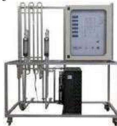
Fig.1 : Dispositif expérimental de l'échangeur thermique eau/eau de type concentrique
